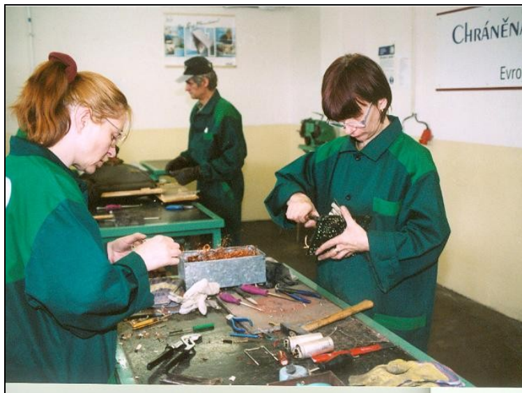
Obr. 1 Ruční demontáž vysloužilých elektrospotřebičů
